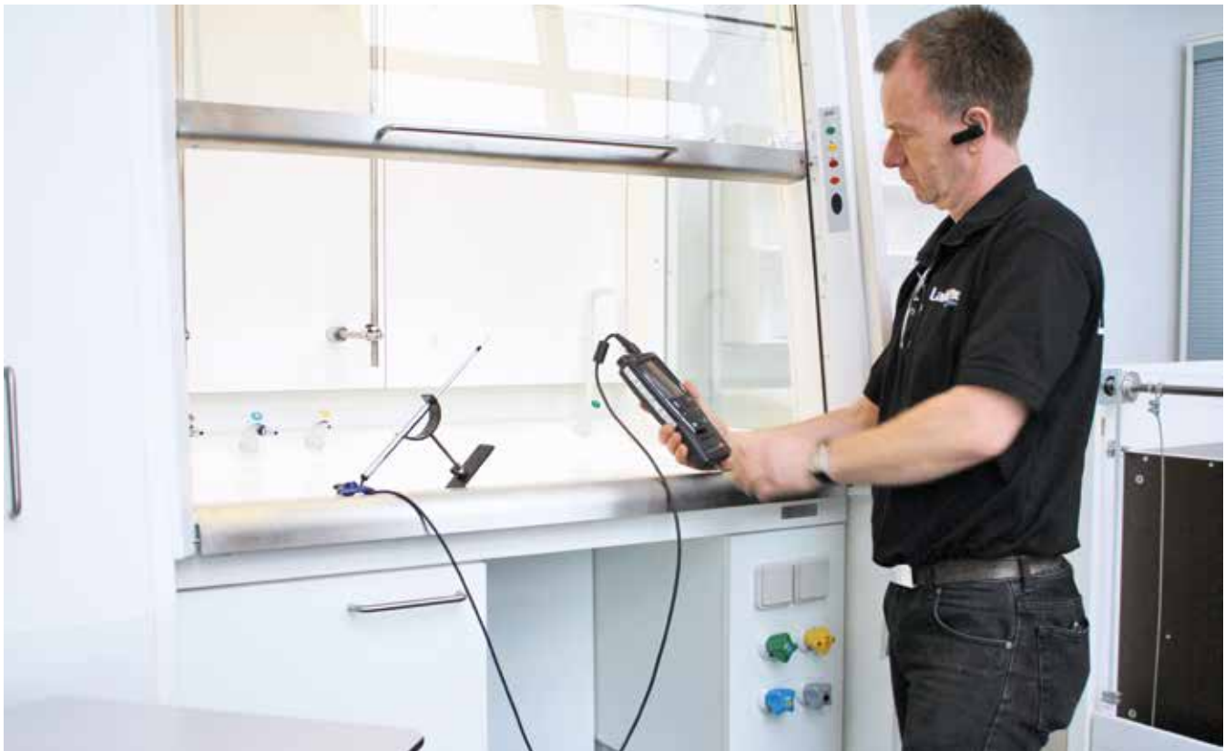
Billede 9 Lufthastighedsmåling i et stinkskab
